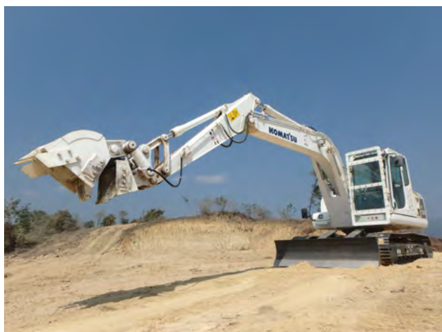
油圧ショベルをベースに開発された対人地雷除去機（不発弾処理用）
