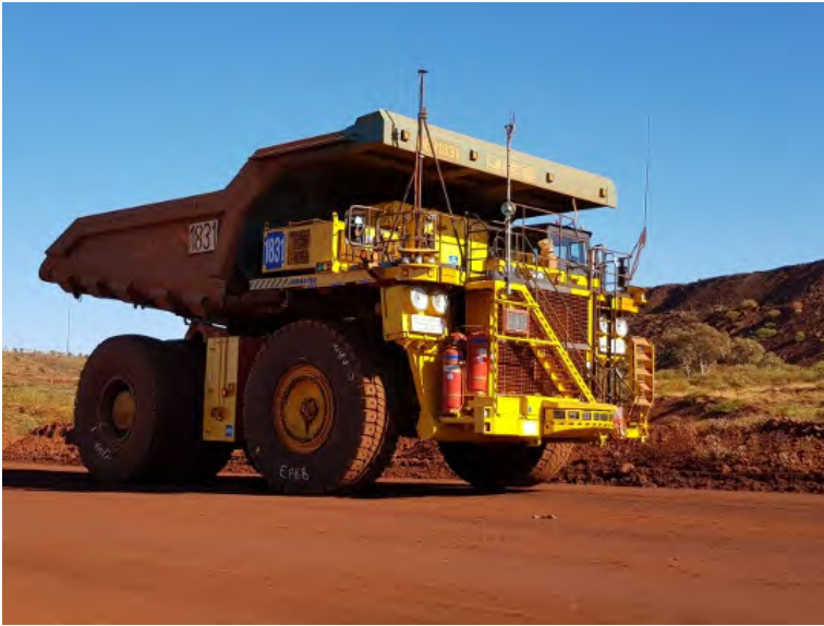
写真：AHS改造後付キットを搭載し無人稼働する830E (場所：豪州Rio Tinto社鉄鉱山)
