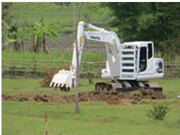
油圧ショベルPC130-8をベースに開発された対人地雷除去機（不発弾処理用）
