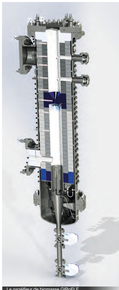
Le gazéifieur de biomasse GIROFLE
