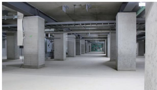
重量物を扱う工場として画期的な全面床下ピット。ライン周りがフラットになり、レイアウト変更も、床板を外し設備を移動させることで比較的容易に実現します。
