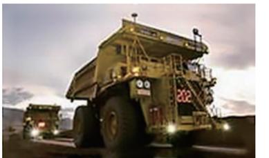
各種ICT機能が搭載されたダンプトラックを、中央管制室で操作・管理し、完全無人稼働を実現させます。ダンプトラックはGPSなどにより自身の位置を把握しながら、管制室から配信された走行コースと速度情報の通りに走行します。
