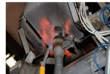
温度差で発電する「熱電素子」を使った廃熱発電システム(栗津工場)。熱処理は温度を急激に変化するので非常に過酷な条件です。
