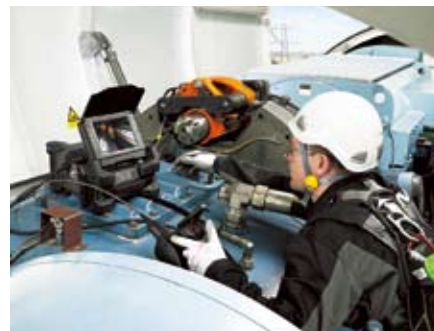
新西兰风力发电站所使用的 工业用影像示波器“IPLEX FX”
