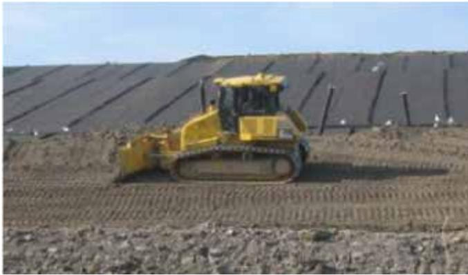
●● 環境に配慮した埋立型ゴミ処理場で稼働するユーザーテスト車（2012年8月）。この現場では法面（斜面）における高精度制御の重要性が確認されました。
