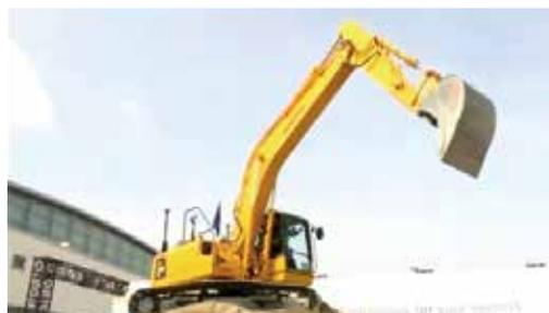
●● 全自動制御機能を備えたマシンコントロール試作油圧ショベル(参考出展)の動画（2013年4月、Bauma）。片手を離しても、設計面をなぞるようにバケットが動作します。
