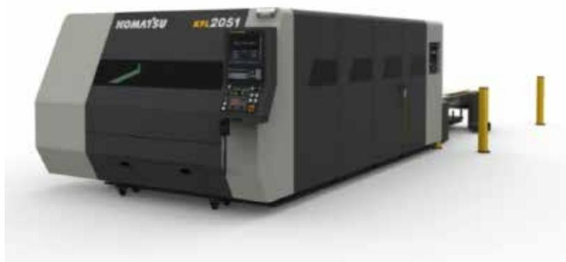
●● コマツ産機が2013年5月に市場導入したファイバーレーザー加工機「KFLシリーズ」は、自社開発のレーザー発振器を搭載し、世界最高レベルの切断速度を実現(ステンレス板1.0mm厚)。ランニングコストも約80%削減しました(当社従来機比)。
