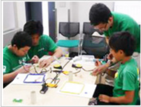
ゲルマニウムラジオ製作の様子 導線を巻いてコイルを作り、部品を基板につなぐ際にはんだ付けを行います
