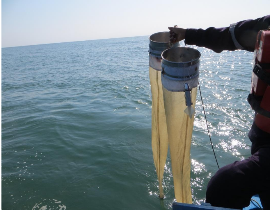
Foto N° 6: Red bongo para muestreo de ictioplancton
