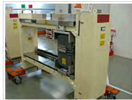
フィルムの厚みの測定に使用している、当社製のWEBFREX3ES（ウェブフレックススリー・イー・エス）
