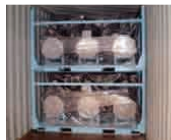
コンテナへのエンジン積載 (中国向けPC200の例:重量積載率98.8%)
